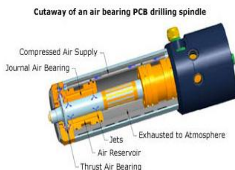
ภาพที่ 1 ส่วนประกอบของหัวเจาะ (spindle) ที่ใช้สำหรับการเจาะในอุตสาหกรรม PCB
