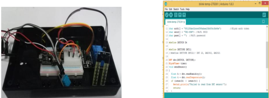
ภาพที่ 3 แสดงอุปกรณ์และคำสั่งโปรแกรมเพื่อเก็บค่าสภาพแวดล้อม
