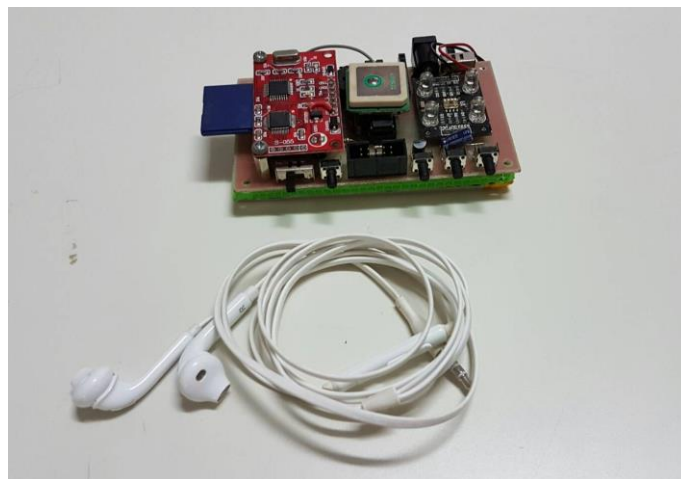
ภาพที่ 3 เครื่องช่วยเหลือคนตาบอดเดินทางโดยรถไฟฟ้าสายกรุงเทพฯ ถึงอยุธยา ด้วย GPS
