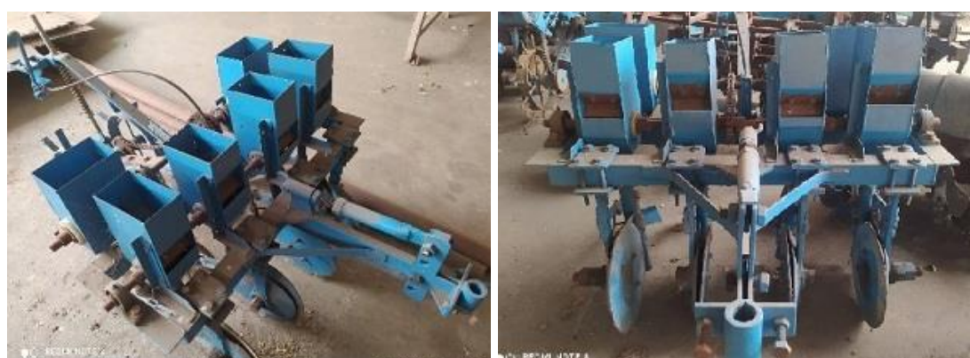
รูปที่ 5 เครื่องต้นแบบหยอดเมล็ดพันธุ์และให้ปุ๋ยแบบ 4 แแถว
