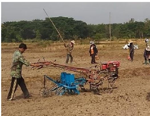
รูปที่ 3 (ก) การทดสอบเครื่องต้นแบบ 3 แถว
