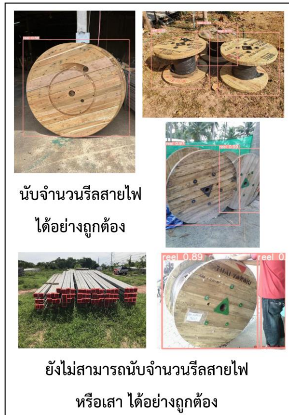
รูปที่ 8 การทดสอบการใช้งานโปรแกรมสำหรับนับจำนวนเสาและรีลสายไฟ
