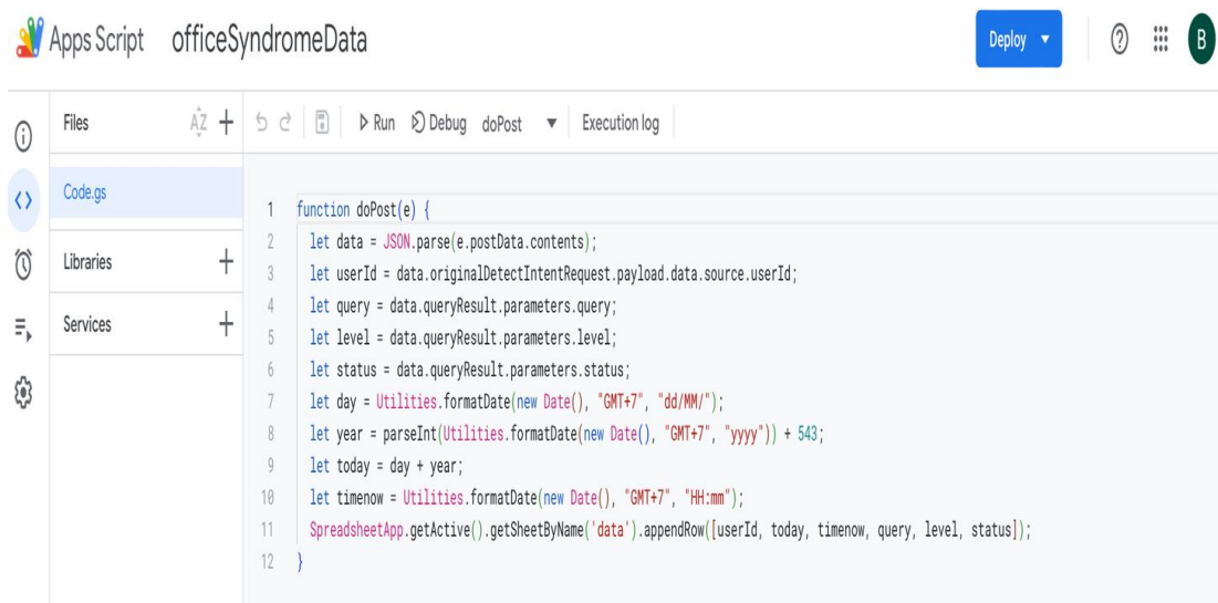
รูปที่ 7 การใช้เครื่องมือ Apps Script เพื่อให้ Google Sheet เชื่อมต่อกับ Dialogflow
