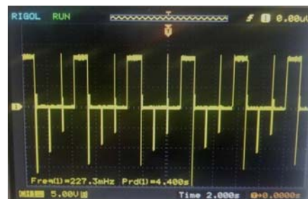
ภาพที่ 8 สัญญาณที่วัดได้จากออสซิลโลสโคปเมื่อปรับค่าการหน่วงเวลา 1,100 ms
