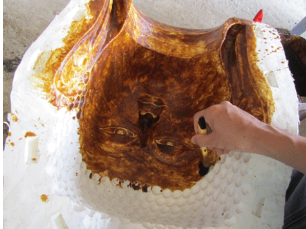
ภาพที่ 3 ตัวอย่างการหล่อขึ้นซึ่งจากพิมพ์ยางซิลิโคน ที่มา: www.montolart.com
