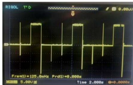
ภาพที่ 10 สัญญาณที่วัดได้จากออสซิลโลสโคปเมื่อปรับค่าการหน่วงเวลา 2,000 ms
