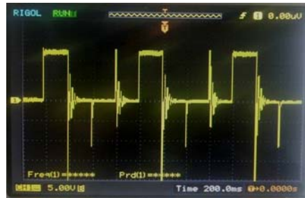
ภาพที่ 6 สัญญาณที่วัดได้จากออสซิลโลสโคปเมื่อปรับค่าการหน่วงเวลา 200 ms
