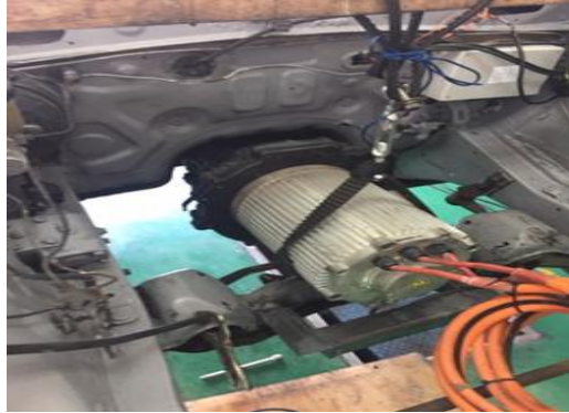
ภาพที่ 9 ติดตั้งชุดเกียร์มอเตอร์ไฟฟ้าเข้ากับรถยนต์
