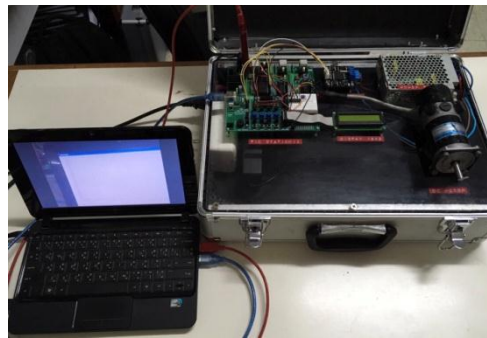
ภาพที่ 4 ชุดทดลองการควบคุมความเร็วรอบมอเตอร์กระแสตรงแบบวงปิด โดยใช้ไมโครคอนโทรลเลอร์ตระกูล PIC รุ่น 18F4431 เชื่อมต่อกับคอมพิวเตอร์
