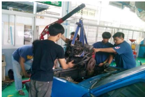
ภาพที่ 7 นำเครื่องยนต์เก่าออกจากรถยนต์
