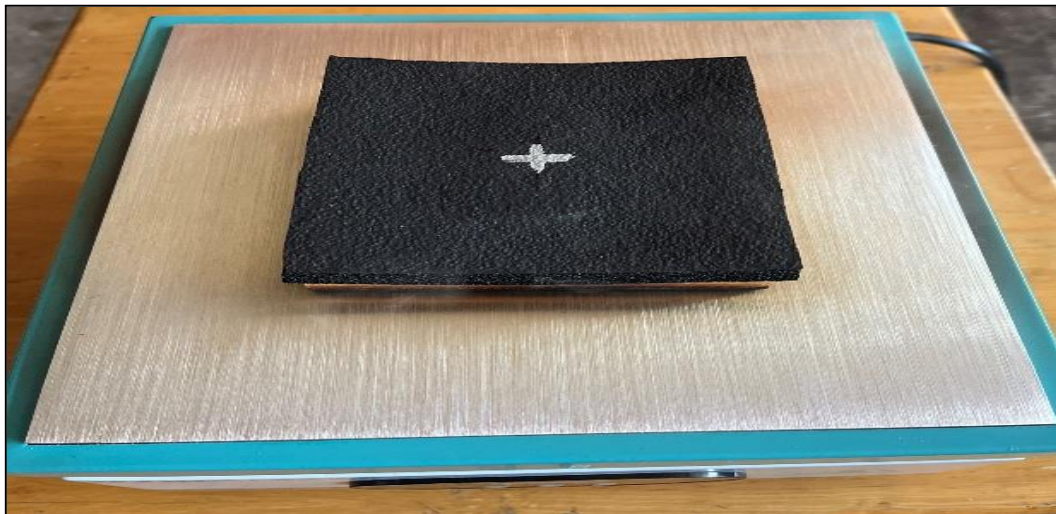
รูปที่ 7 ชิ้นงานที่ติดฉนวน บนเครื่องให้ความร้อน (ที่มา: การทดสอบโดยผู้วิจัย)
