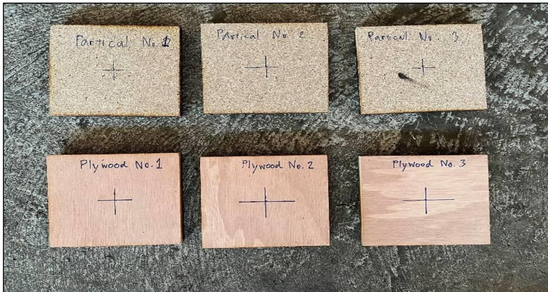
รูปที่ 3 ไม้ Particle Board และ ไม้ Plywood (ที่มา: การทดสอบโดยผู้วิจัย)
