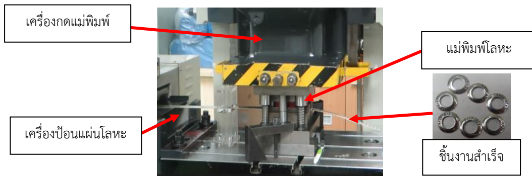
รูปที่ 2 การทำงานของแม่พิมพ์ขึ้นรูปโลหะแบบต่อเนื่อง
