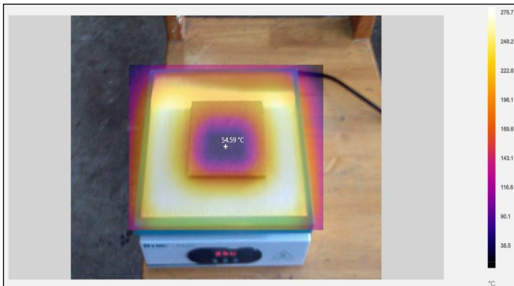
รูปที่ 4 วางชิ้นงานไว้บนเครื่องให้ความร้อน (ที่มา: การทดสอบโดยผู้วิจัย)
