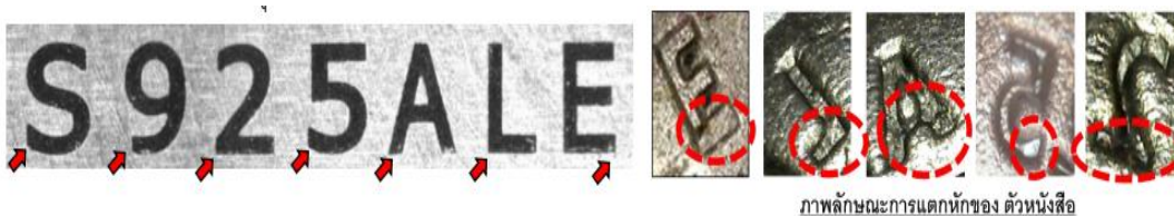
รูปที่ 5 ตำแหน่งที่เกิดการแตกร้าวของชิ้นงานปัจจุบัน
