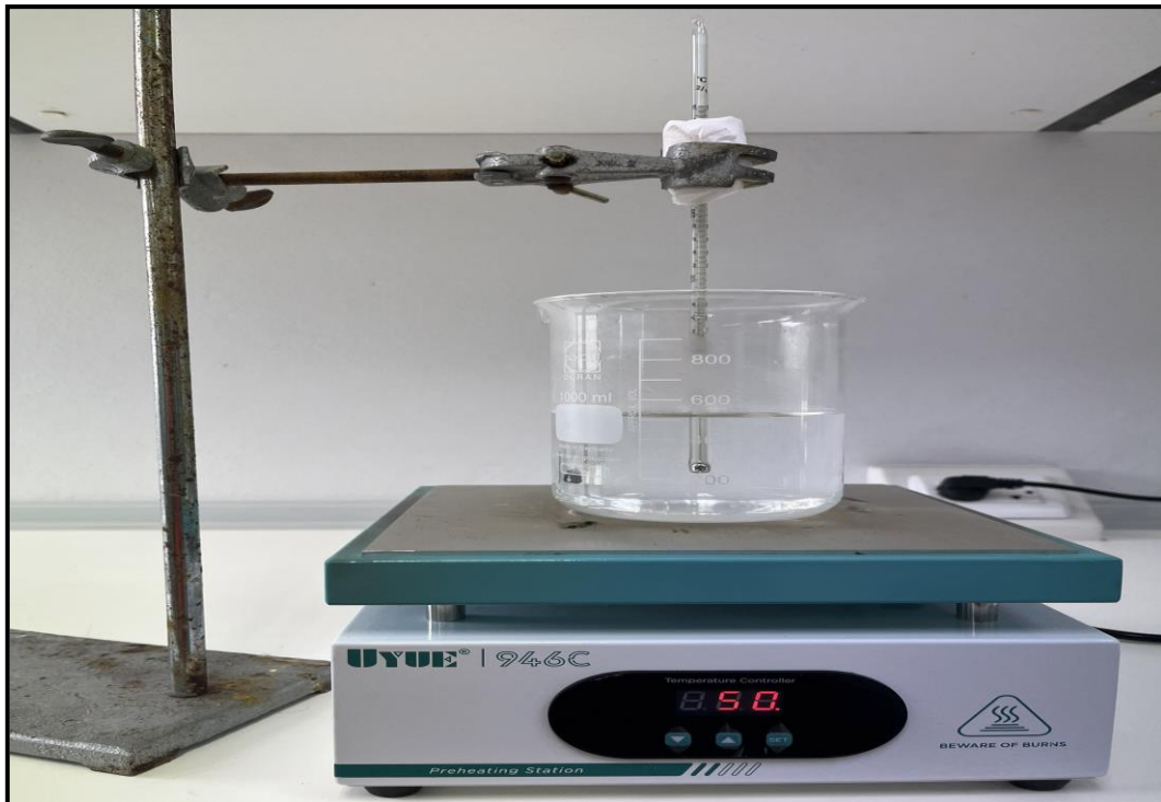
รูปที่ 8 การทดสอบหาปริมาณความร้อนของเครื่องให้ความร้อน (ที่มา: การทดสอบโดยผู้วิจัย)
