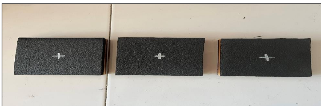
รูปที่ 6 ชิ้นงานที่ติดฉนวน EPDM (ที่มา: การทดสอบโดยผู้วิจัย)
