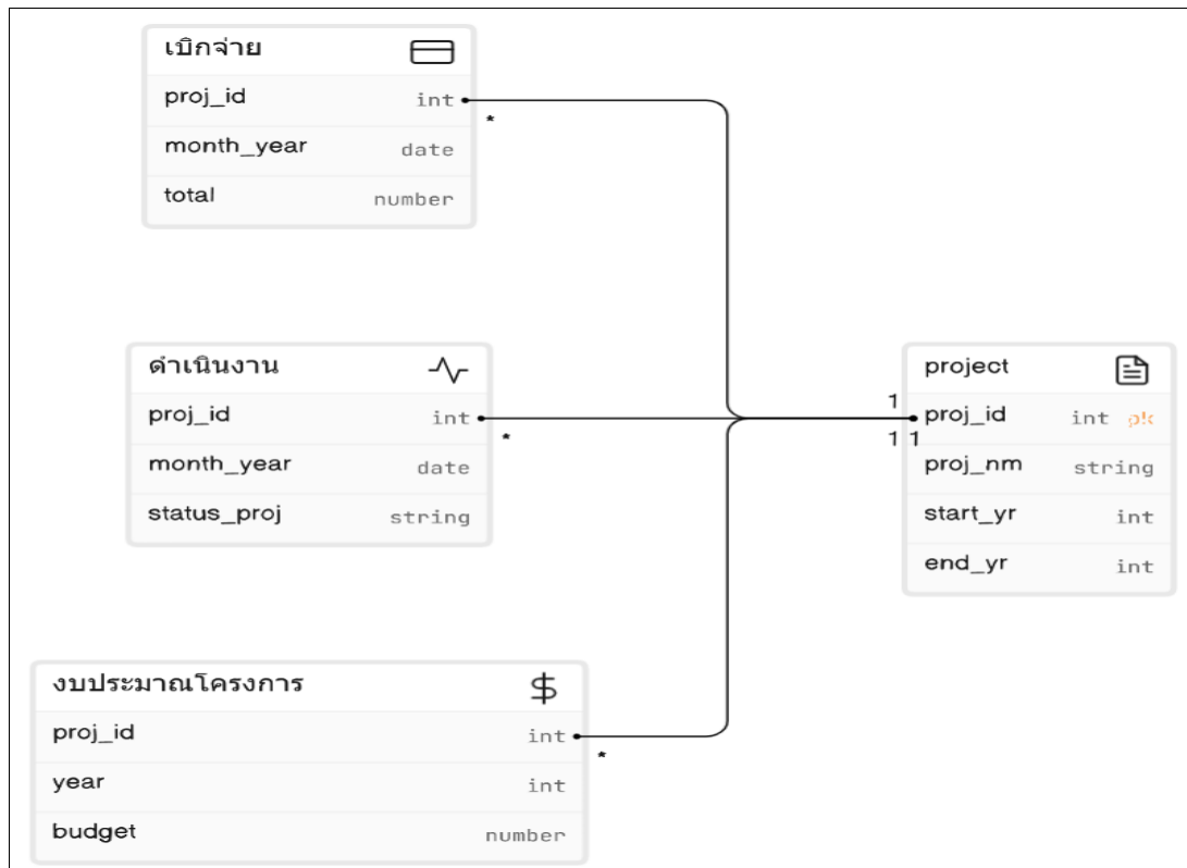
รูปที่ 4 ตัวแบบข้อมูล (Data Model)
