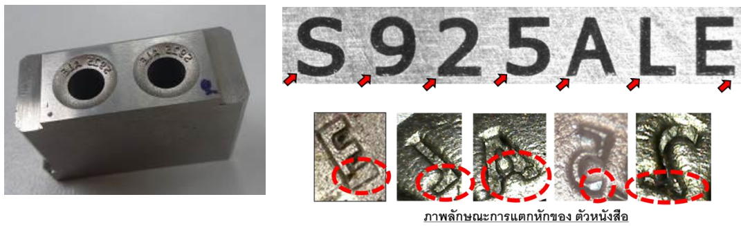
รูปที่ 3 จุดแตกหักบริเวณตัวอักษรในชิ้นส่วนขึ้นรูปของแม่พิมพ์
