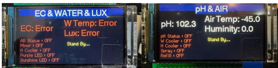
รูปที่ 8 แสดงส่วนของแสดงสถานะต่าง ๆ ของระบบผ่านหน้าจอ LED ของทั้ง 2 บอร์ด
